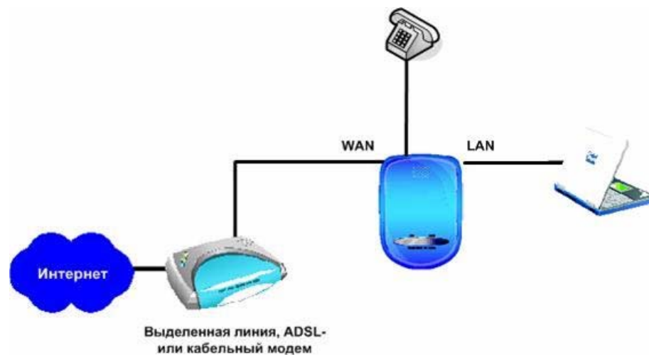
Рис. 2.3 Схема включения шлюза при использовании шлюза как NAT-маршрутизатора/моста
